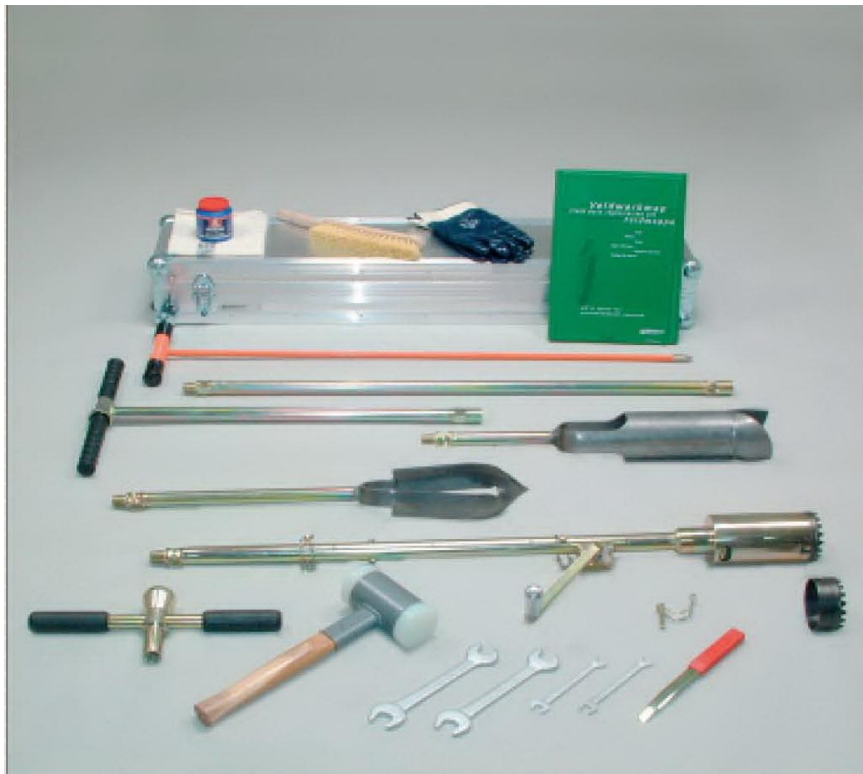
ภาพที่ 7 อุปกรณ์การเก็บตัวอย่างดินในการศึกษาการชะล้างพังทลายของดิน
