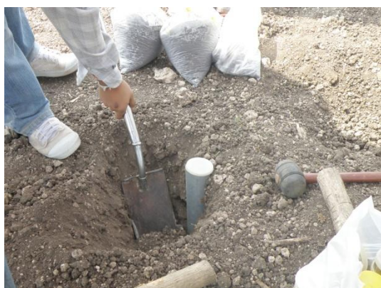
ภาพที่ 8 การเก็บตัวอย่างดินด้วยท่อทรงกระบอกที่ดัดแปลง
